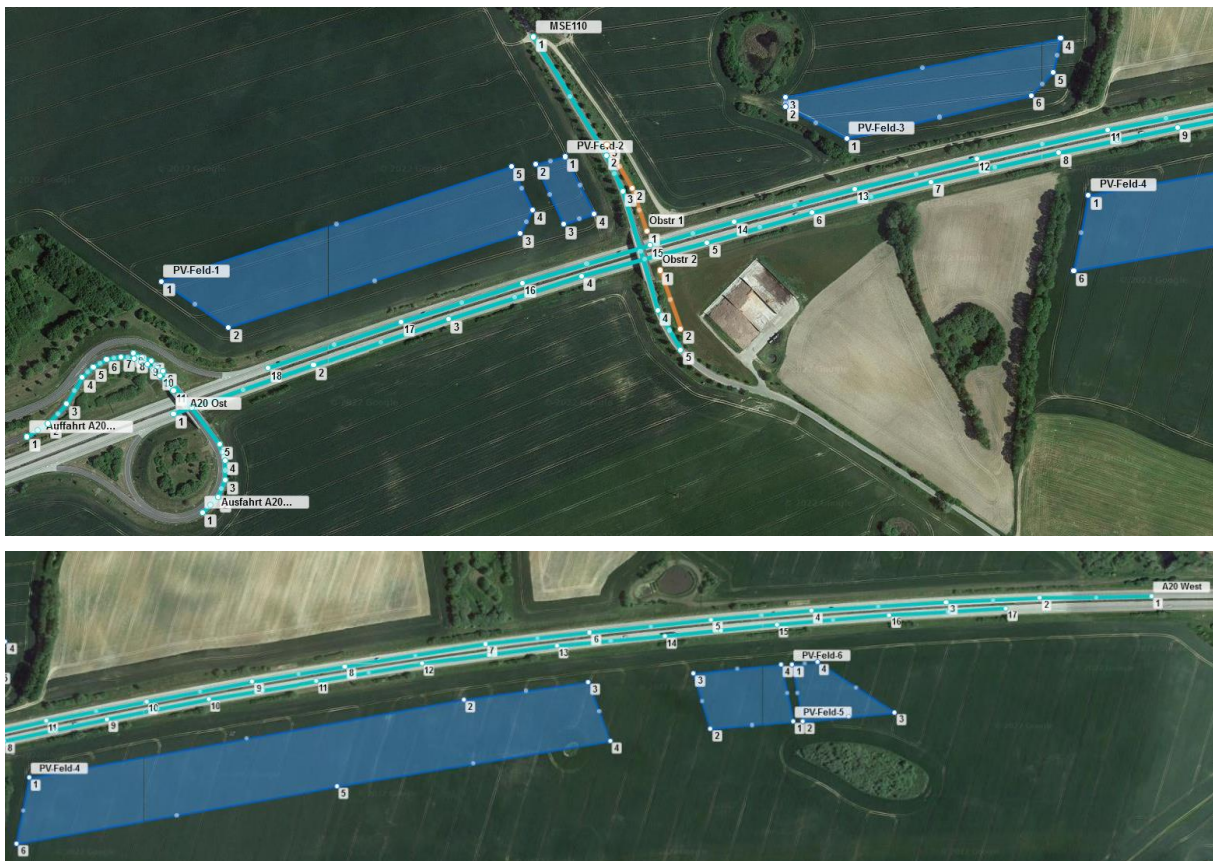
Abbildung 12: Anlage des geplanten Solarparks in der Simulationssoftware „ForgeSolar“ oben: westlicher Teil mit PV-Feldern 1 & 2, unten: östlicher Teil des Solarparks mit PV-Feldern 3-6
